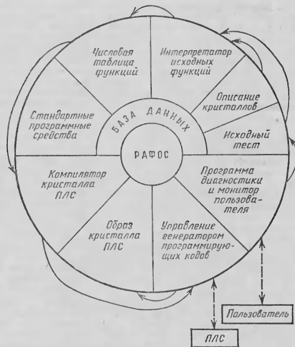
Рис. 1. Блок-схема программного обеспечения САПР ПЛС
