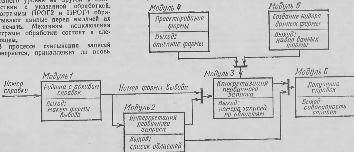
Рис. 2. Взаимосвязь программных модулей, обрабатывающих запрос на получение справок
